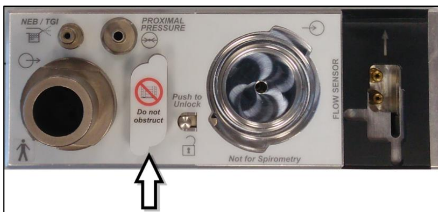
Figura 3-7. Detalhe do Painel Lateral – Válvula Anti-Asfixia.
